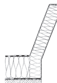
AK típusú acél-alumínium kompozit lábazat 40 cm magas
