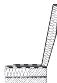
Acél-alumínium kompozit lábazat RAK típusú hő- és füstelvezetéshez, 30 cm magas
