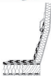
GFK-RAK hő- és füstelvezetéshez opcionális, üvegszál erősítésű köténylemezzel (rálógó csík)
